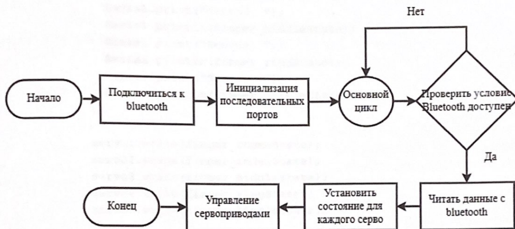
Рисунок 2.13 – Блок схема программы протеза руки для управление сервоприводами
