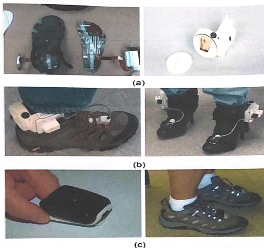
Рисунок 1.9 – Три итерации управления ногами: (а) FSR-нога, подключенная к АСІ(интерфейс управления действиями) (слева) и блок АСІ и батарея (справа); (b) IMU-1 и блок батареи АСІ, надетые на обувь (слева) и ботинки (справа); (c) IMU-2 на клипсе (слева) и на шнурках (справа) [11]
